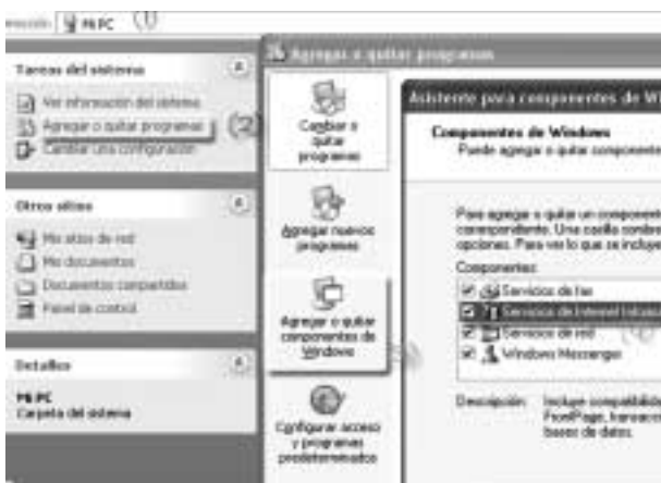
Fig. 2: Cuadro de diálogo para añadir el Servidor de Internet en Windows XP Profesional.
