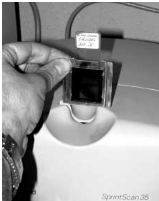
Fig. 1: Con el fin de poder escanear más fácilmente las preparaciones y conseguir un mejor foco, se han ideado dispositivos que sirven para escáneres de diapositivas. El modelo que se muestra en la fotografía ha sido diseñado por el Dr. Atienzar.
